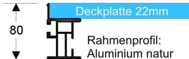
Das Podest ist für die Aufnahme von 4 Alu-Steckbeinen 40/40 mm in fixen Höhen oder für Teleskopbeine ausgerüstet.
